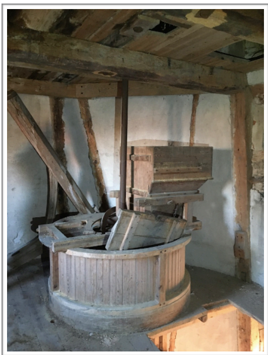
Fig. 25-26. Kärings kvarnverk med stenparet samt rötskador och vitmögel på hättans norrgavel.
