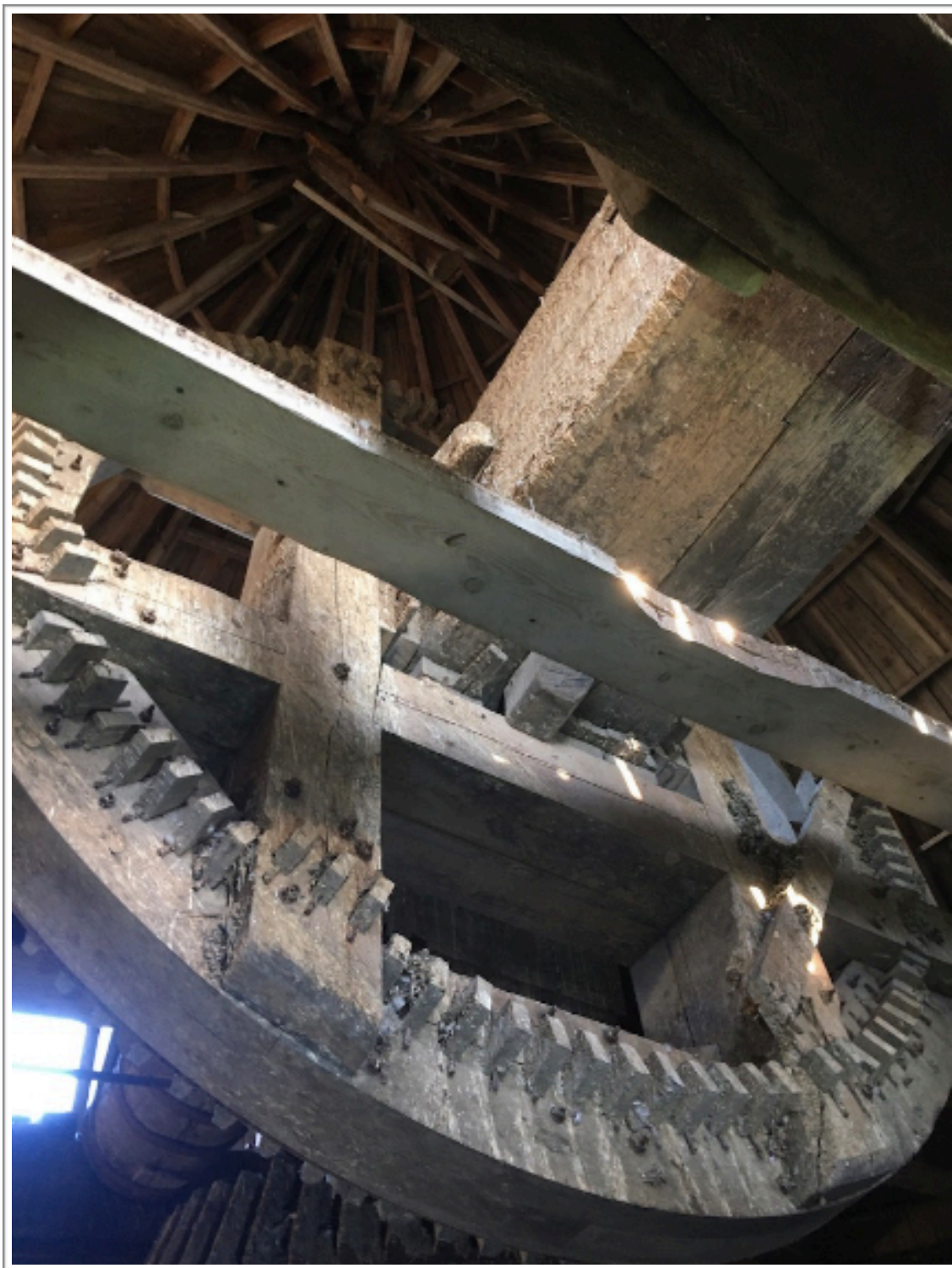
Fig. 33. Plågans enorma kronhjulet samt axel fotograferat upp mot hättan.
