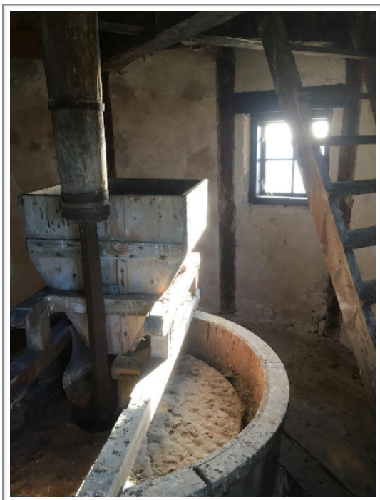
Fig. 14-15. Hela kvarnmekanismen är frånsett mindre skador i fint skick. Här syns stenparet samt stenkarret. Bilden till höger visar kronhjulets topp som drabbats av röta pga. läckage från hättans spira.
