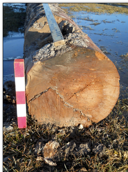
Fig. 4. Okstocken var avsågad i toppändan. Lägg märke till sågmärkena efter sågbladet samt att snittet tagits om.
